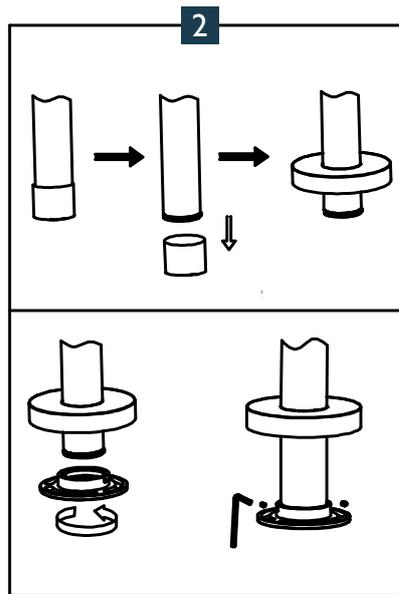
2. Verwijder het omhulsel van de badkraan. Schuif de rozet over de buis, hierna de flens en zet het geheel vast met schroeven.
