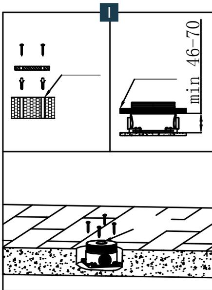
1. Bepaal de positie voor de bodemplaat en maak hiervoor ruimte in de vloer. Monteer de waterleiding op de warm wateraansluiting (links) en koud wateraansluiting (rechts). Zet de bodemplaat vast op de vloer.
